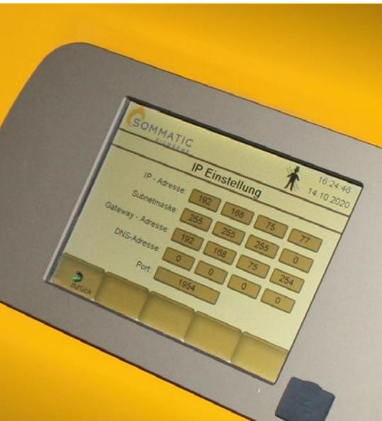
↑ Touch-Bedienfelder mit einfacher Menüführung und selbsterklärenden Bildern gewährleistet eine einfache Bedienung.
