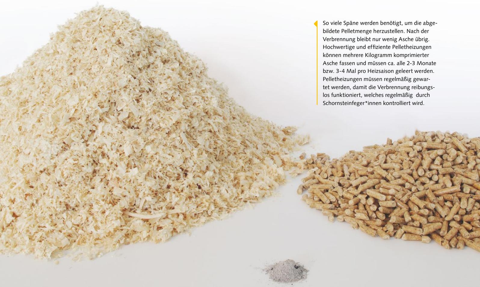
◀ So viele Späne werden benötigt, um die abgebildete Pelletmenge herzustellen. Nach der Verbrennung bleibt nur wenig Asche übrig. Hochwertige und effiziente Pelletheizungen können mehrere Kilogramm komprimierter Asche fassen und müssen ca. alle 2-3 Monate bzw. 3-4 Mal pro Heizsaison geleert werden. Pelletheizungen müssen regelmäßig gewartet werden, damit die Verbrennung reibungslos funktioniert, welches regelmäßig durch Schornsteinfeger\*innen kontrolliert wird.
